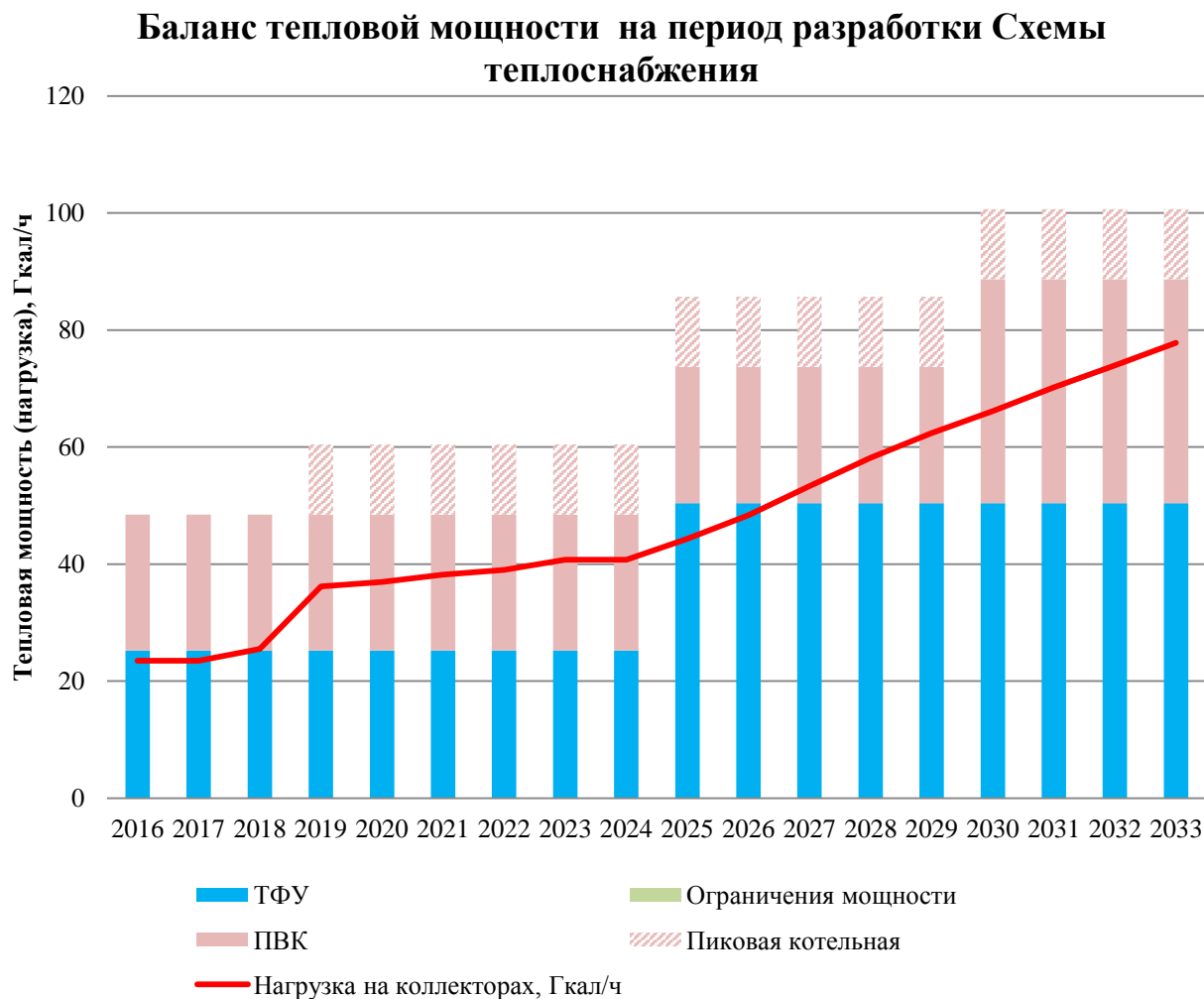
Рисунок 16 – Баланс тепловой мощности ГТУ-ТЭЦ
