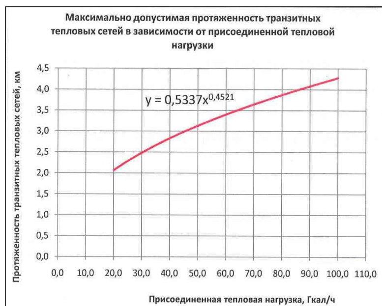
Рисунок 8 - Максимально допустимая протяженность тепловых сетей в зависимости от присоединенной тепловой нагрузки до 5 Гкал/ч
