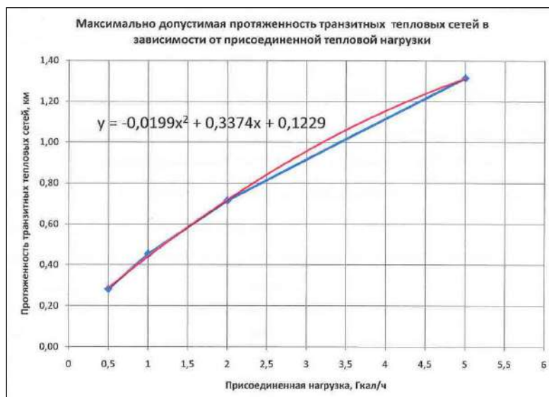
Рисунок 8 - Максимально допустимая протяженность тепловых сетей в зависимости от присоединенной тепловой нагрузки до 5 Гкал/ч
