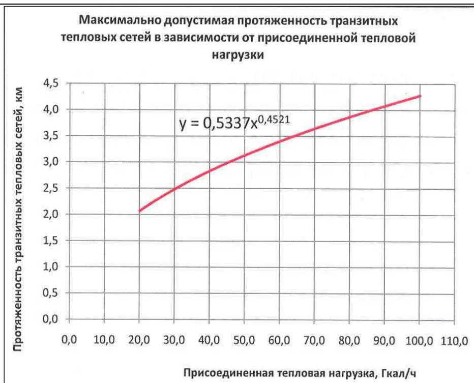
Рисунок 37 - Максимально допустимая протяженность тепловых сетей в зависимости от присоединенной тепловой нагрузки от 20 Гкал/ч
