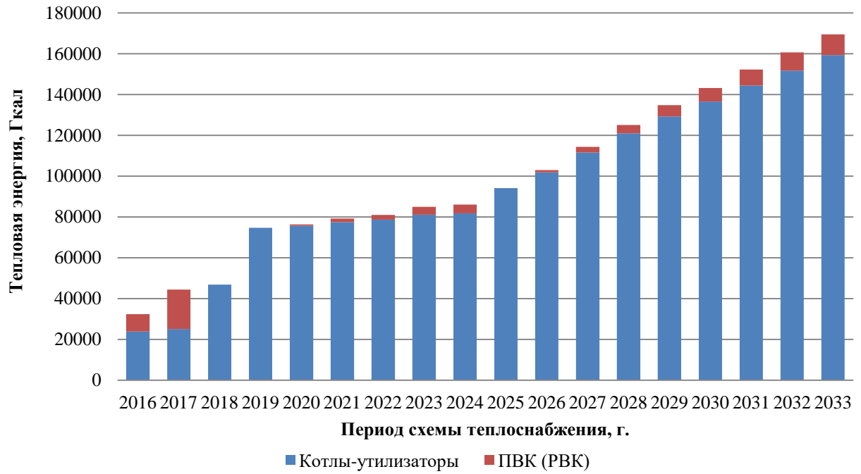
Рисунок 28 – Баланс выработки тепловой энергии группами оборудования ГТУ-ТЭЦ
