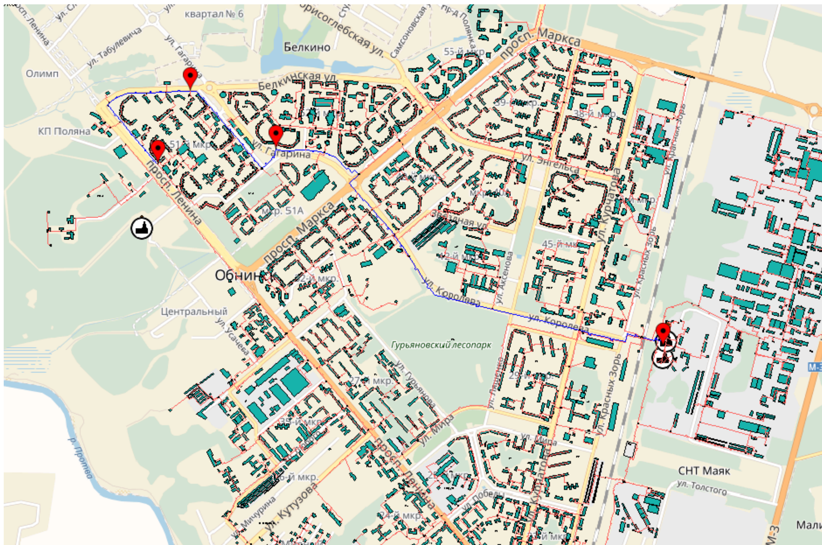
Рисунок 14 – Путь построения пьезометрического графика магистральных тепловых сетей от котельной МП «Теплоснабжение» по ул. Королева, ул. Гагарина, ул. Белкинской и пр. Ленина до ТК-
