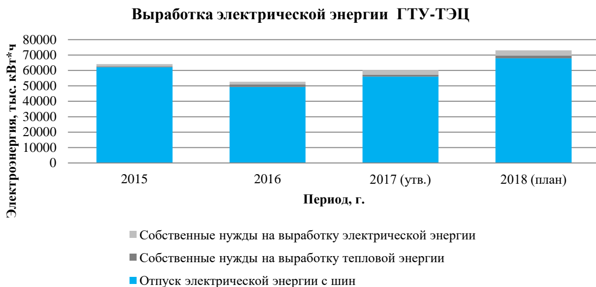
Рисунок 6 – Балансы выработки электрической энергии на оборудовании ГТУ-ТЭЦ
